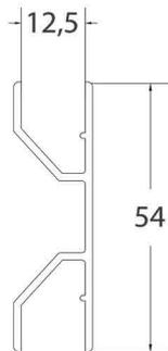
PVC extruido con lamina de terminación.
