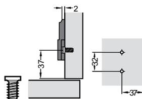
Placa con tornillo premontado alt. 2 mm.
