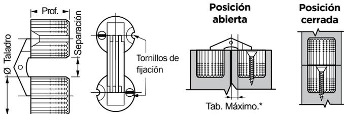
\*La medida de Tab Máximo debe respetarse rigurosamente en el lado interno, evitando así la interferencia entre hojas.
