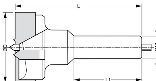
Brocas con filos de carburo de tungsteno, para agujereadoras múltiples y máquinas CNC.
