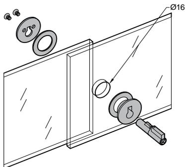
Para cristales hasta 6mm de espesor.
