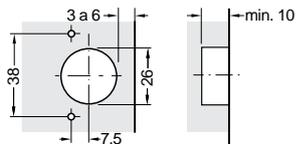
Para atornillar en sistema de orificios 38/7,5 mm.
