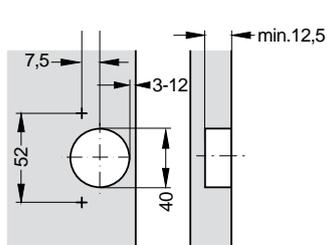
Espesor de puerta 24 hasta 35 mm.
