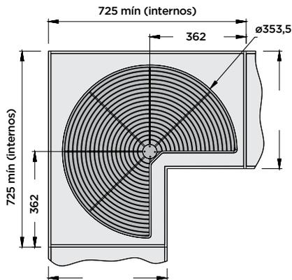
Espesor de pared lateral: 18 mm
