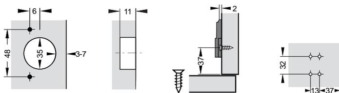
Para sistema de orificios 48/6 mm
