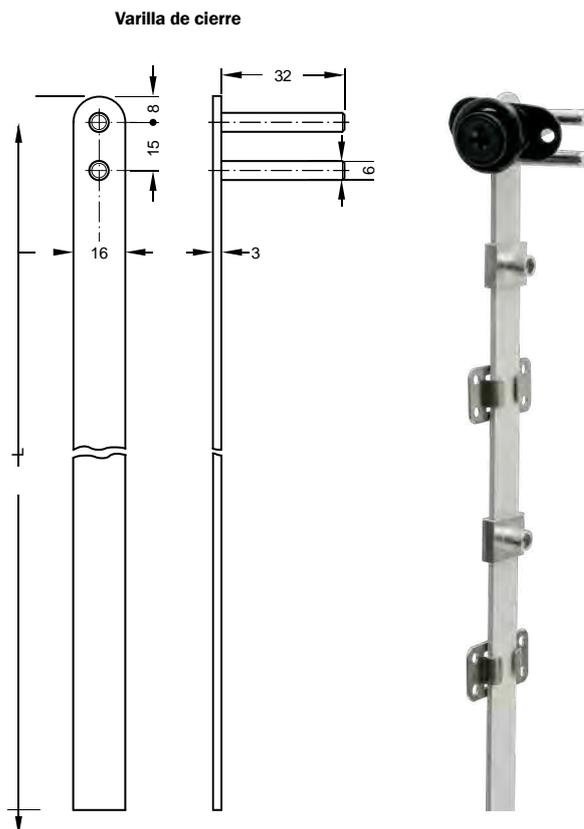
Con varilla de 600 mm / 1 m / 1,5 m de largo y carrera de 8 mm.
