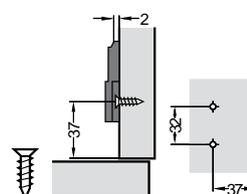
Placa con tornillo premontado alt. 2 mm.
