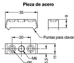
Para montaje rápido de gabinetes, con tornillo de unión.
