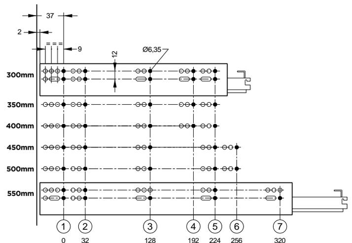
**Guía oculta Soft Closing con sistema sincrónico y regulación 3D. Extensión total**
