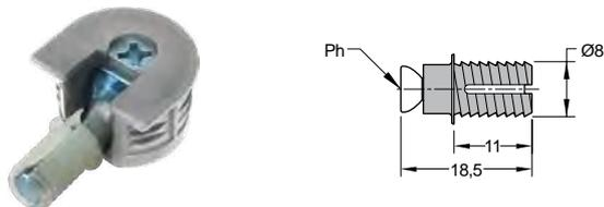
Para sujeción entre estantes y gabinetes, por medio de un sistema de caja concéntrica y perno.
