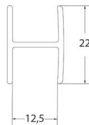
PVC extruido con lamina de terminación.
