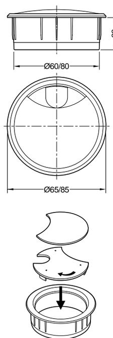
Para montaje sobre escritorios en calado de  $\varnothing 60$  y  $\varnothing 80$  mm.
