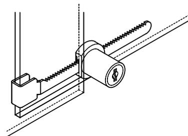
Para cristales de 4 mm hasta 7 mm de espesor.
