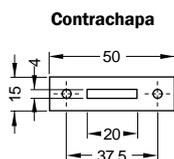
Para cristales hasta 6 mm de espesor.
