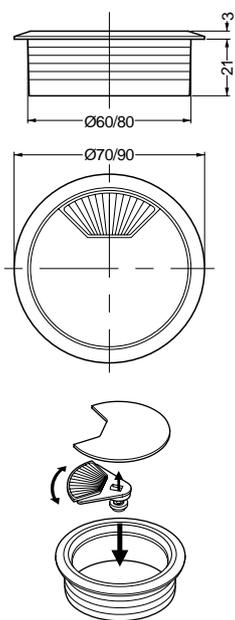
Para montaje sobre escritorios en calado de  $\varnothing 60$  y  $\varnothing 80$  mm.
