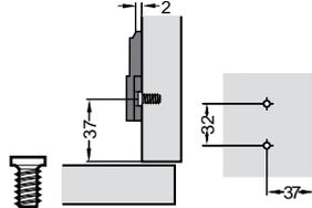
Placa con tornillo premontado alt. 2 mm.
