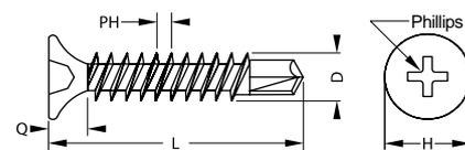
Se utilizan para la vinculación de los perfiles entre sí y la unión de las distintas placas a dichos perfiles.
